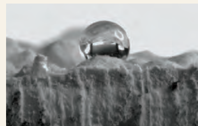
Wassertropfen auf hydrophobem herkömmlichen Putz
