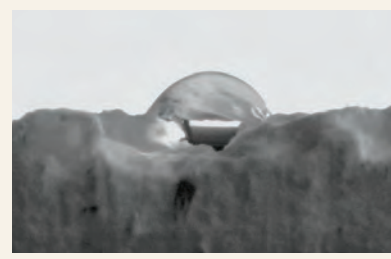
Wassertropfen auf hydrophilem Baumit NanoporTop
